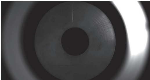
第6図 マルチエフェクトライトによる縦キズの観察画像
